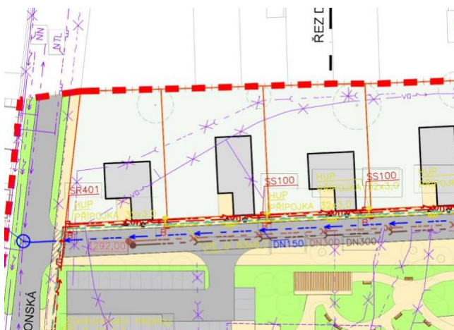
situace - napojení na dopravní a technickou infrastrukturu
