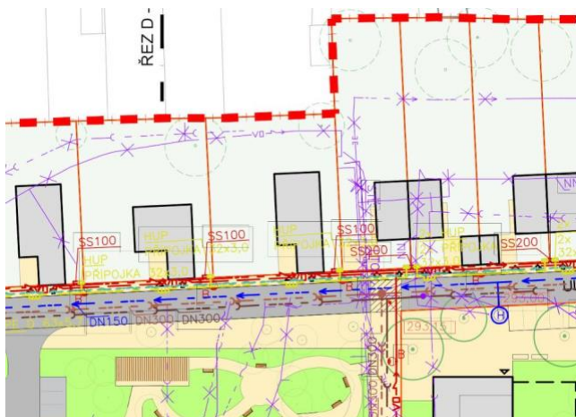
situace - napojení na dopravní a technickou infrastrukturu
