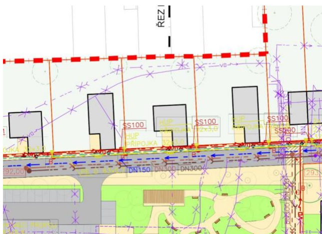
situace - napojení na dopravní a technickou infrastrukturu
