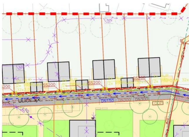
situace - napojení na dopravní a technickou infrastrukturu
