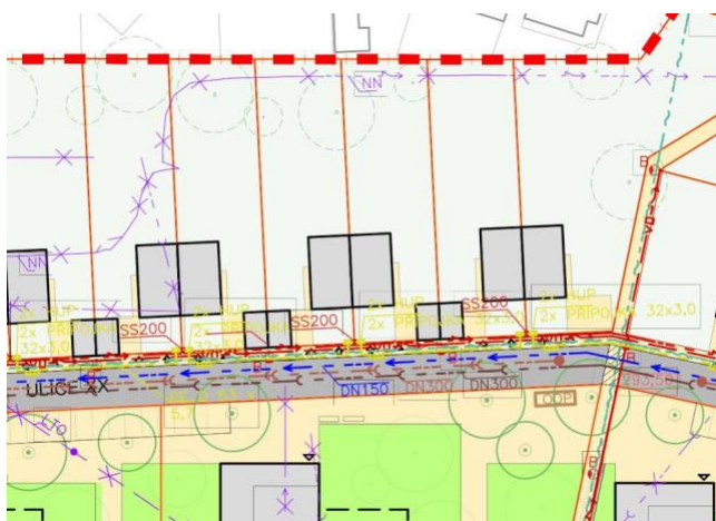
situace - napojení na dopravní a technickou infrastrukturu
