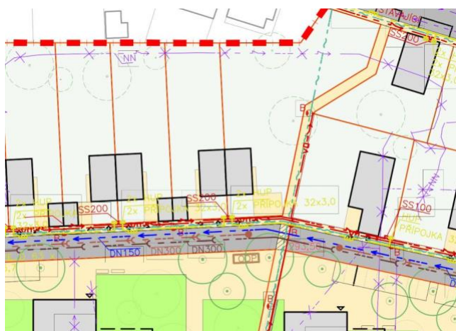
situace - napojení na dopravní a technickou infrastrukturu
