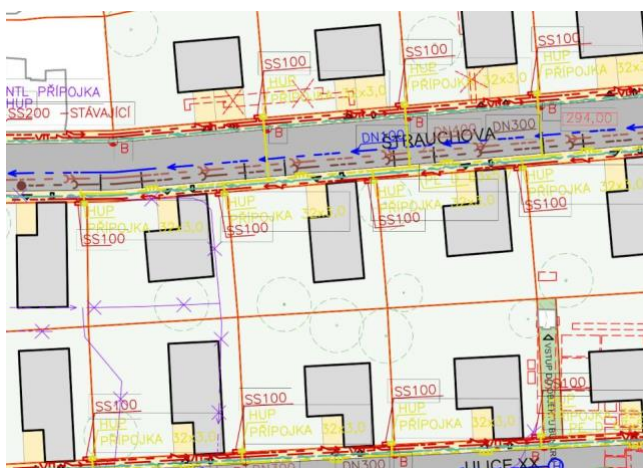
situace - napojení na dopravní a technickou infrastrukturu
