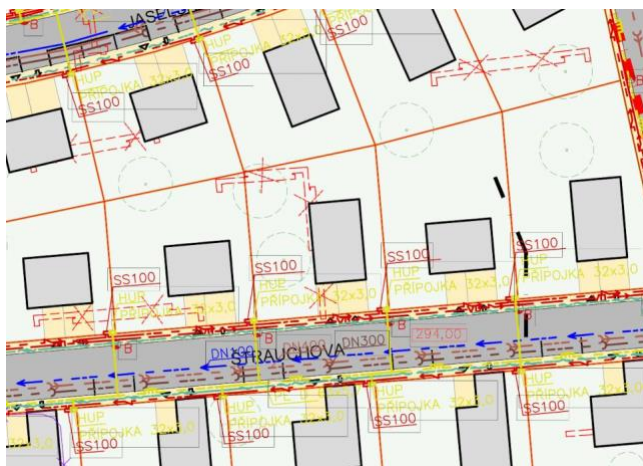
situace - napojení na dopravní a technickou infrastrukturu
