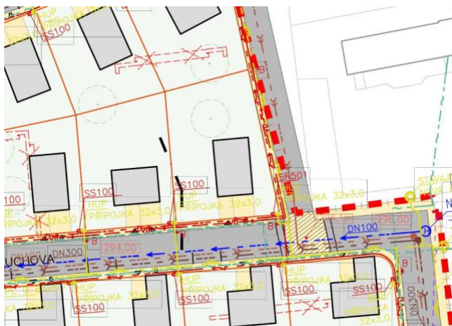
situace - napojení na dopravní a technickou infrastrukturu
