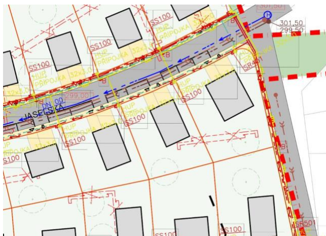
situace - napojení na dopravní a technickou infrastrukturu
