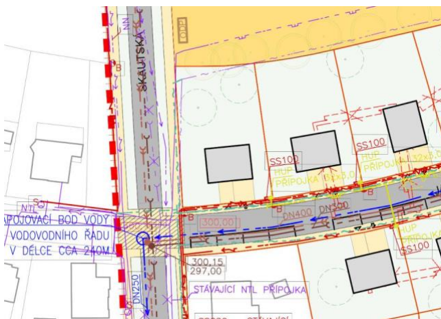
situace - napojení na dopravní a technickou infrastrukturu
