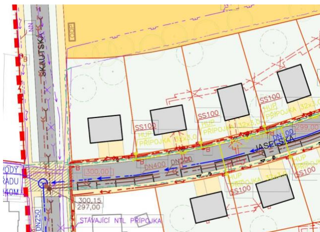
situace - napojení na dopravní a technickou infrastrukturu
